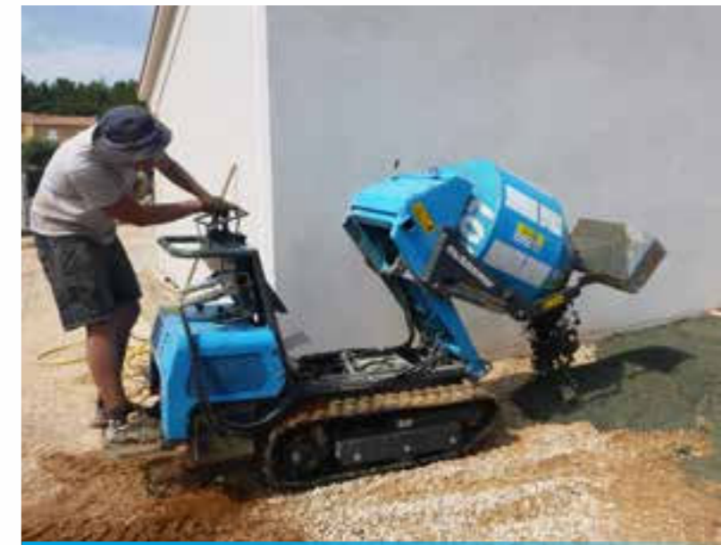
Concrete mixer, 180 l mixed capacity Betonmischer, mischkapazität 180 l
